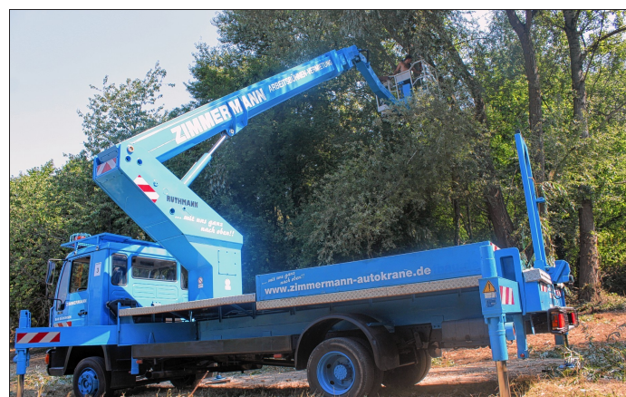
Schweres Gerät: Mittels Hubbühne werden die Baumkontrolleure bis hinauf in die Kronen in Frage kommender Bäume gehievt.
